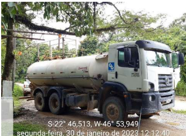
Foto 162 – Realização da umectação das vias externas. (Data:30/01/2023)
