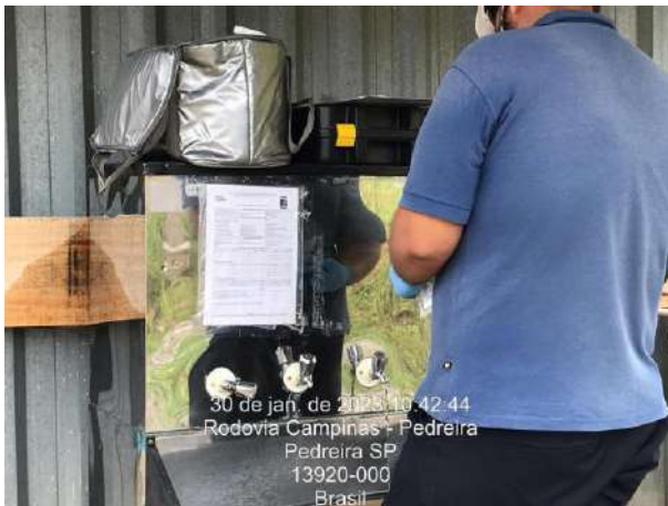
Foto 50 - Coleta de água para análise de potabilidade – Bebedouro do container da fundação (Data:30/01/2023)
